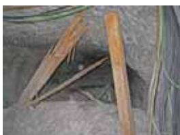
Senkungen im Salzbergwerk Asse
